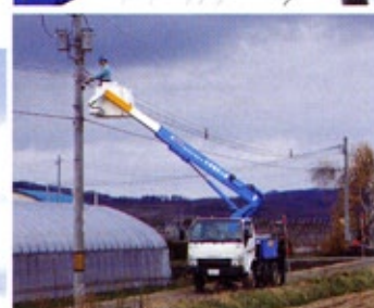
電気工事に出勤したSH12A。多種多様な作業内容に対応するため、車両の右側をアオリ付きの荷台にした特別仕様となっている
