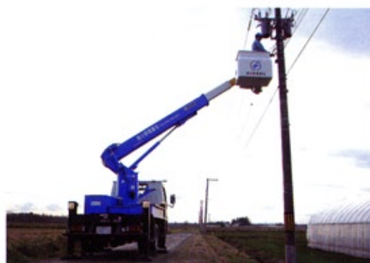
電気工事に出勤したSH12A。多種多様な作業内容に対応するため、車両の右側をアオリ付きの荷台にした特別仕様となっている
